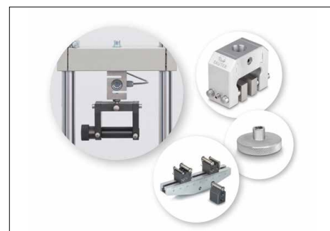
Possibilités de fixation solides et flexibles de nombreux accessoires et pinces de la gamme SAUTER, voir Accessoires
