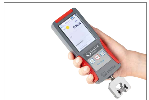
Dynamomètre compact avec cellule de mesure interne (jusqu'à 500 N max.) pour les mesures de force rapides et mobiles. L'illustration montre un accessoire optionnel, la pince à vis SAUTER AE 500
